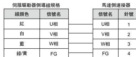
(2) 不帶保持煞車器的伺服馬達接線規格: 750W, 1.5kW
