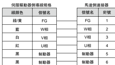
(3) 帶保持煞車器的伺服馬達接線規格: 100 ~ 400W
